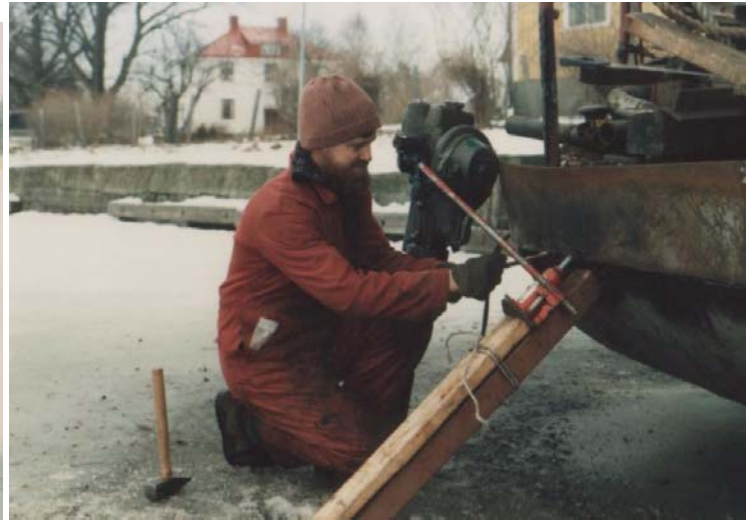
Kvick fastfrusen vid Norsholms fyr. Från isen kan Carl Axel jobba lättare. Akterplåtarna pressas upp på plats med hjälp av en domkraft som tar spjörn mot isen.
